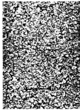
Abb. 3. Elektronenmikroskopisches Bild einer spiegelnden Schicht. |——| 1 \mu .
